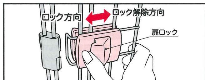
● 扉ロックを右にスライドし、手前に引くとロックが解除され扉が開きます。扉を閉めてロックから手を離すとバネの力でロックされます。
